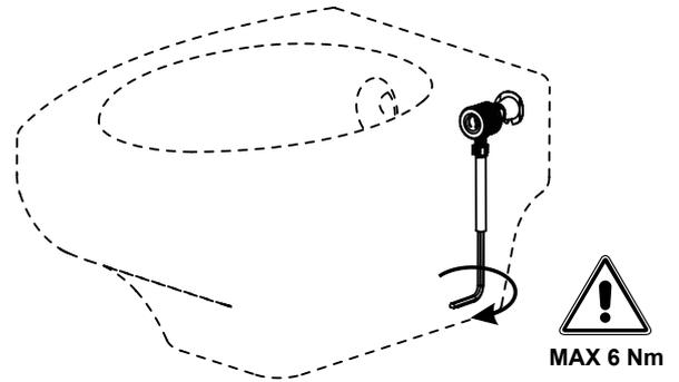
Avvitare i due dispositivi WB9 B inserendo la chiave di serraggio nei due tubetti. (Max 6 Nm).
